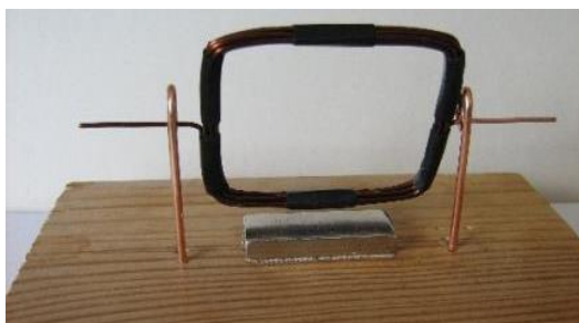
Rys. 1a Prymitywny silnik prądu stałego (PSPS) - model wirtualny: uzwojenie/cewka twornika (1), nieizolowane podpory miedziane A 1 i A 2 , stojan/podstawa/ i magnes trwały (3)
